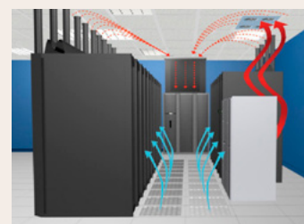
CRAC-enheder (klimastyring af serverrum)
